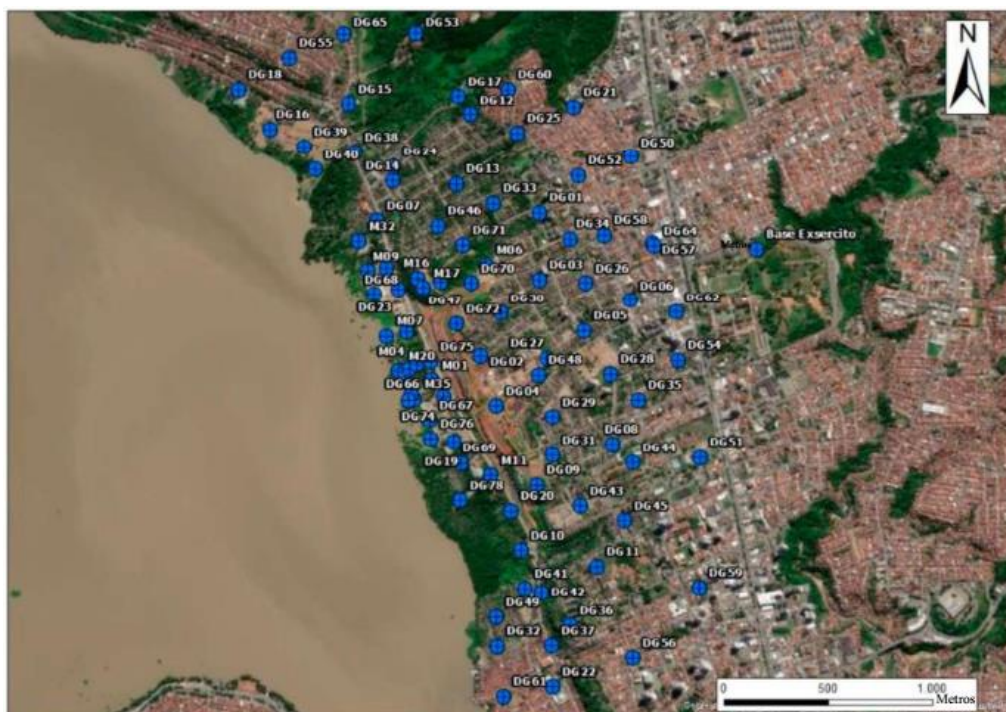
Figura 2 - Distribuição das antenas GNSS na área afetada pelo processo de subsidência. Fonte: Geoapp (2025).
